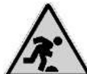
Pericolo di inciampo
